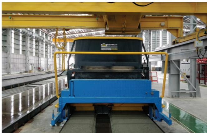
La possibilità di produrre contemporaneamente 2 pannelli di larghezza diversa (0,8 e 1,20 m) sottolinea la flessibilità della Slipformer S-Liner.
