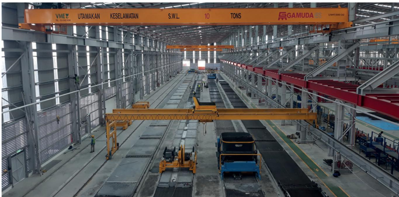
*Echo ha installato quattro piste di produzione di 150 m di lunghezza e 2,4 m di larghezza ciascuna e una Echo Slipformer S-Liner.*
