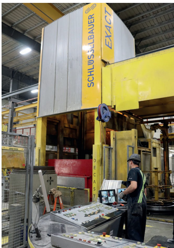
La machine de tuyaux et d'éléments de regard Exact Schlüsselbauer, également en service depuis de nombreuses années
