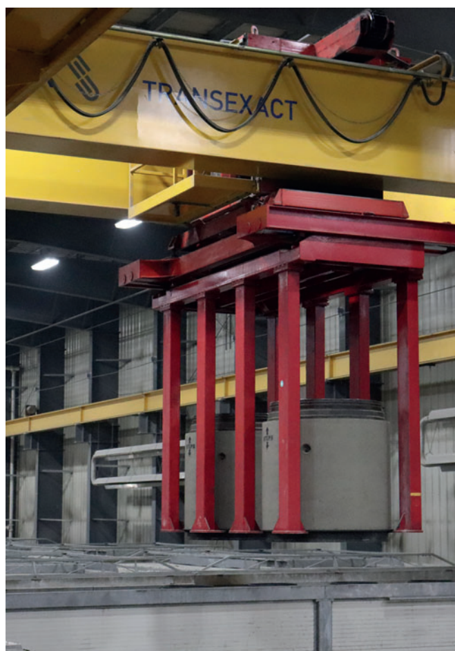
La machine de tuyaux et d'éléments de regard Exact Schlüsselbauer, également en service depuis de nombreuses années
