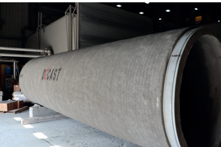
Tubo de presión terminado en el control de calidad
