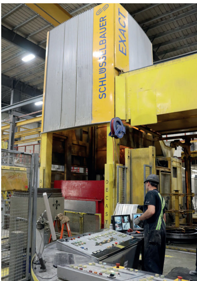
Otro éxito en uso desde hace mucho tiempo: máquina de componentes para pozos y tubos Exact de Schlüsselbauer
