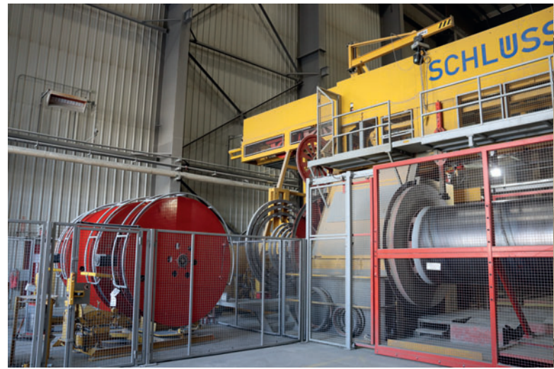
La máquina de pretensado de alta velocidad de Schlüsselbauer Technology se ha integrado como parte fundamental para mejorar el proceso en la línea de producción.
