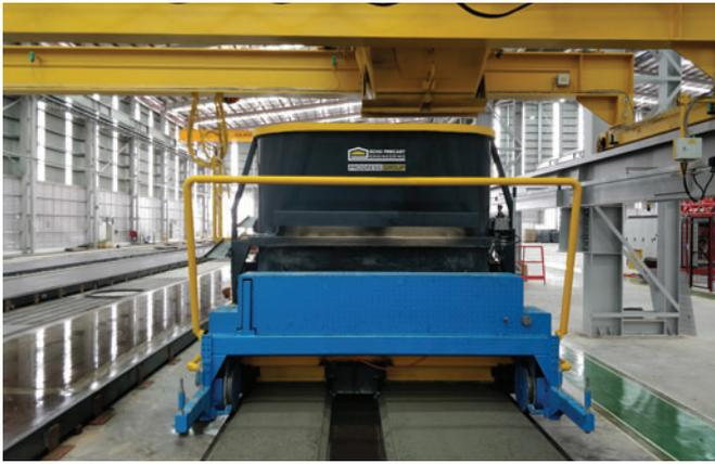
La posibilidad de fabricar simultáneamente 2 placas con diferentes anchuras (0,8 y 1,20 m) resalta la flexibilidad de la Slipformer S-Liner.
