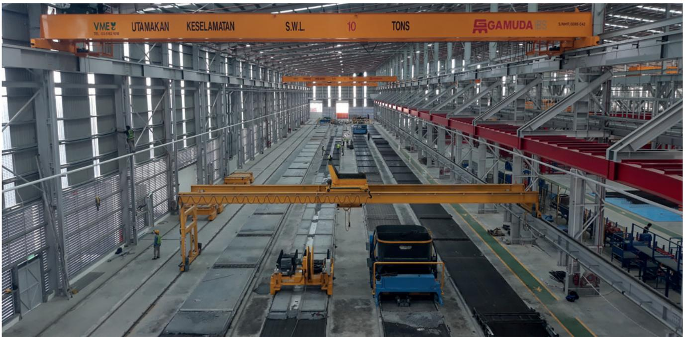
*Echo ha instalado cuatro líneas de producción con una longitud de 150 m y una anchura de 2,4 m cada una, así como una Echo Slipformer S-Liner.*
