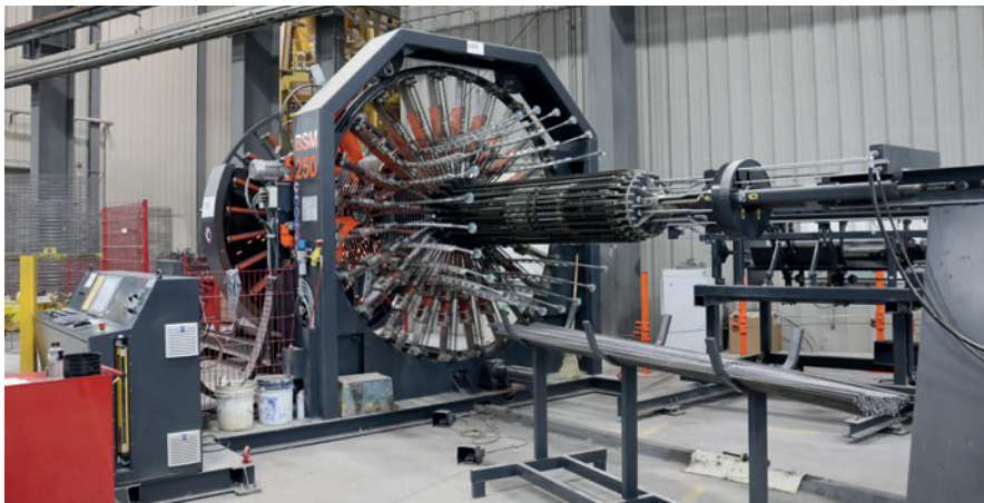
Seit kurzem ergänzt die Korbschweißmaschine BSM 250 den Maschinenpark in der Bewehrungshalle
