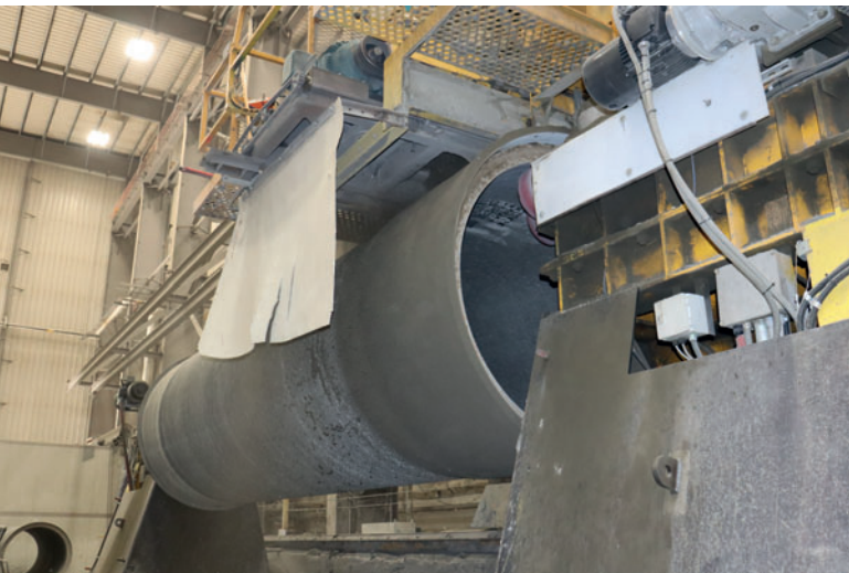
Die Beschichtungsanlage trägt eine Schutzschicht aus Betonmörtel auf den Vorspanndraht auf.
