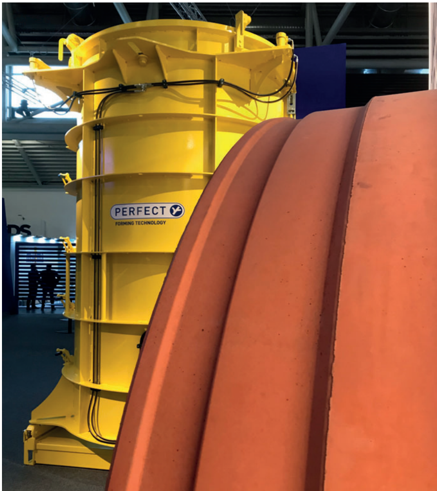
Изготовленная на заказ труба с уплотнительной камерой на гладком конце показывает все возможности сложной производственной системы Perfect Forming Technology
