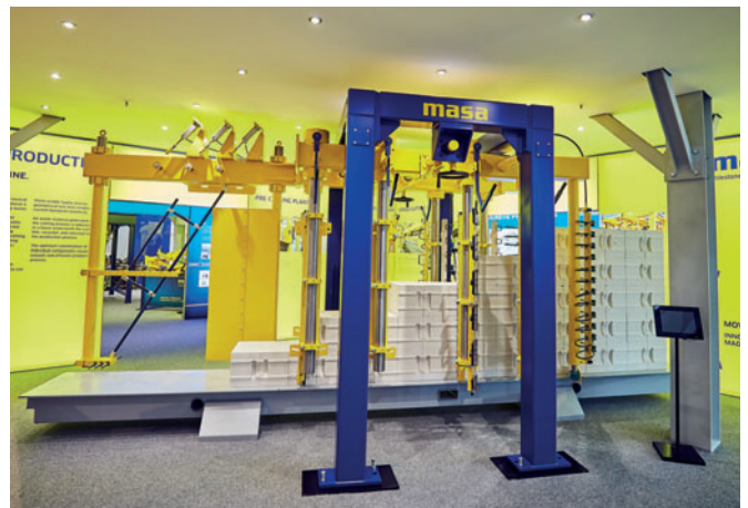
Станция резки и профилирования боковых поверхностей газобетонных изделий
