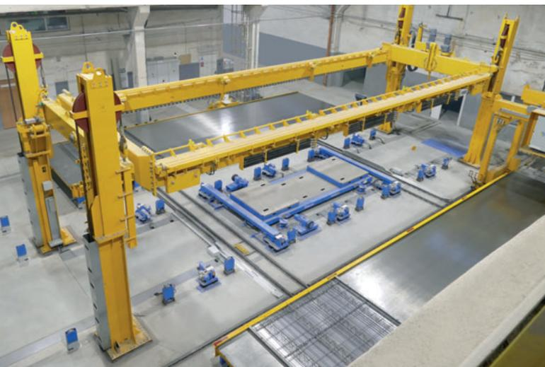
*Кантователь паллет – один из основных элементов карусельной установки для производства двойных стеновых элементов*
