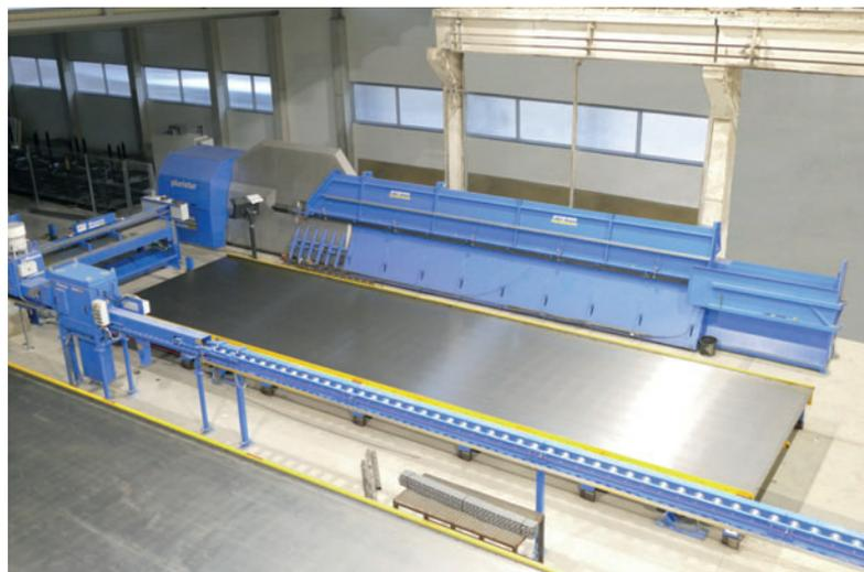
*Pluristar представляет собой скобогибочный автомат, правильную машину и стол с двумя гибочными головками. Установка была успешно интегрирована в новый карусельный завод от EbaWe*
