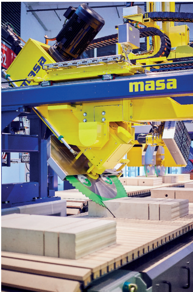
Technologia cięcia wyrobów z silikatów.
