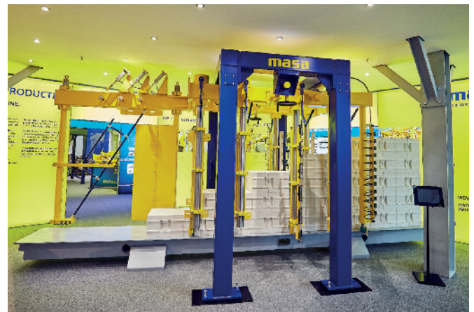
Stanowisko cięcia i profilowania wyrobów z betonu komórkowego.
