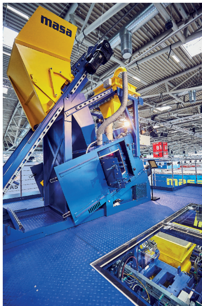
Mieszarka do betonu licowego, typ S 350/500.
