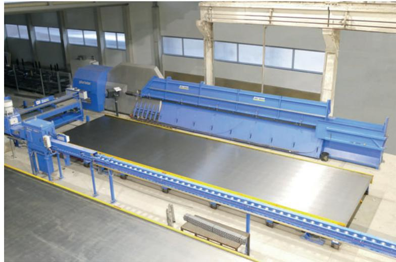
*La Pluristar della progress Macchinari & Automazione è una staffatrice, raddrizzatrice e piegatrice doppia automatica. È stata perfettamente inserita nel nuovo impianto a carosello di pallet di Ebawe.*
