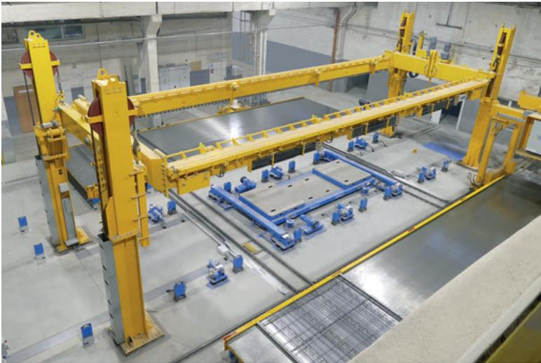
*Il dispositivo di rotazione dei pallet è il nuovo cuore della produzione delle pareti a doppia lastra dell'impianto a carosello.*
