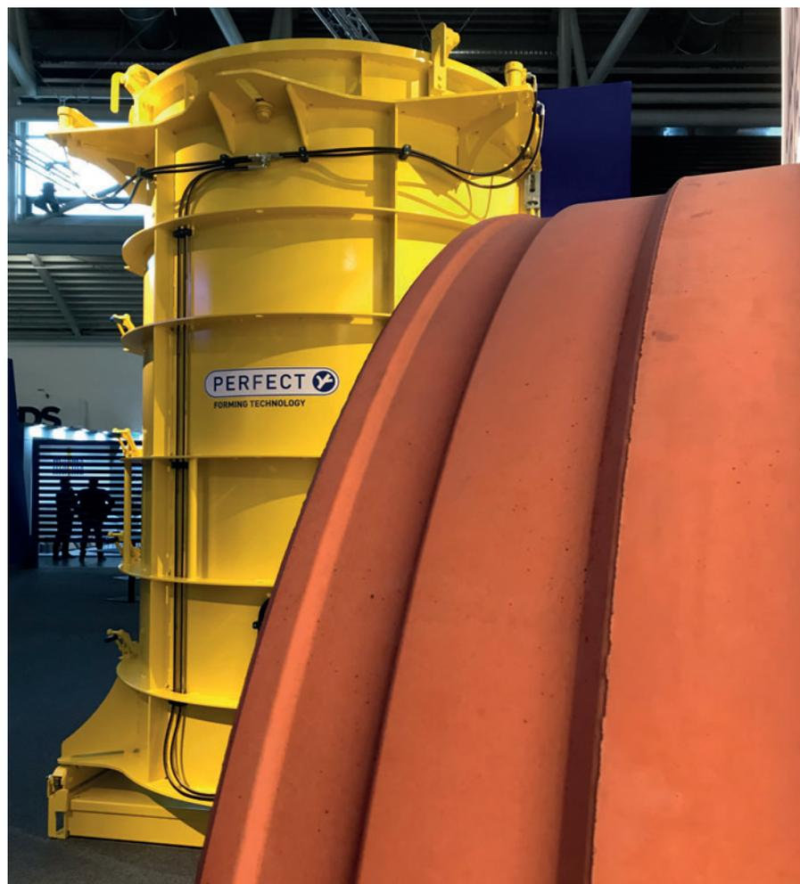
*L'esecuzione del tubo, dimensionalmente esatta e con camera di tenuta sull'estremità maschio, evidenzia le possibilità di Perfect Forming Technology quale sistema di produzione ben congegnato.*
