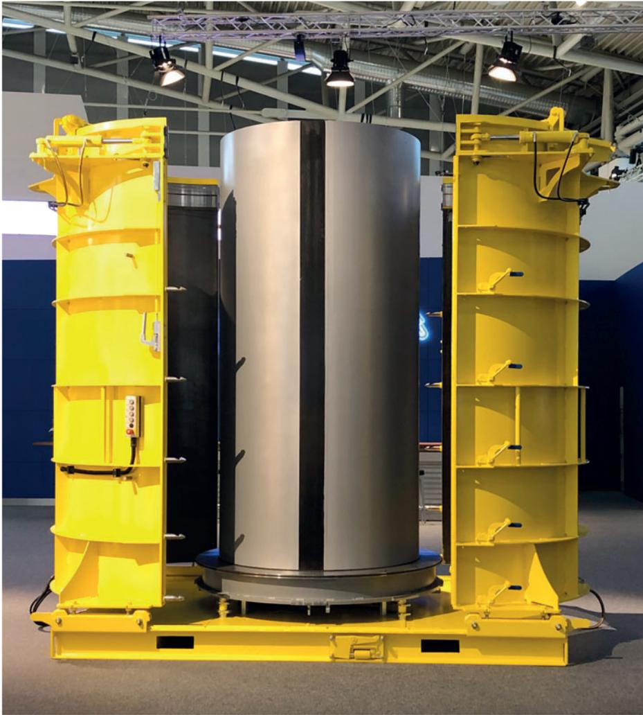
*Come esempio del sistema di produzione Perfect Forming Technology, Schlüsselbauer ha esibito proprio quello stampo con nucleo rientrante (shrinking core) privo di manutenzione e con una sformatura dotata di protezione dell'estremità maschio con cui, pochi giorni prima, è stato prodotto il tubo in esposizione.*
