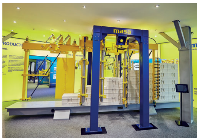
Stazione di taglio laterale e profilatura dei prodotti in calcestruzzo cellulare
