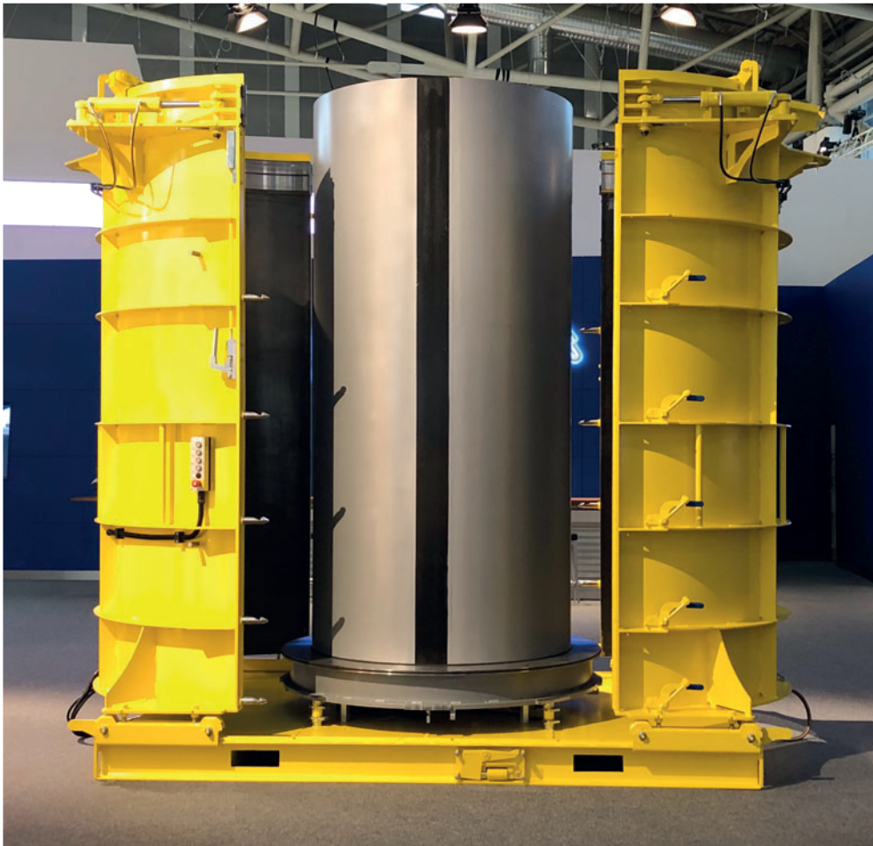
Le moule avec le noyau rétractable ne nécessitant aucun entretien et la technique précautionneuse de démoulage de l'about mâle présenté par Schlüsselbauer témoigne de la technologie « Perfect Forming Technology ». C'est le moule dans lequel a été fabriqué le tuyau exposé.
