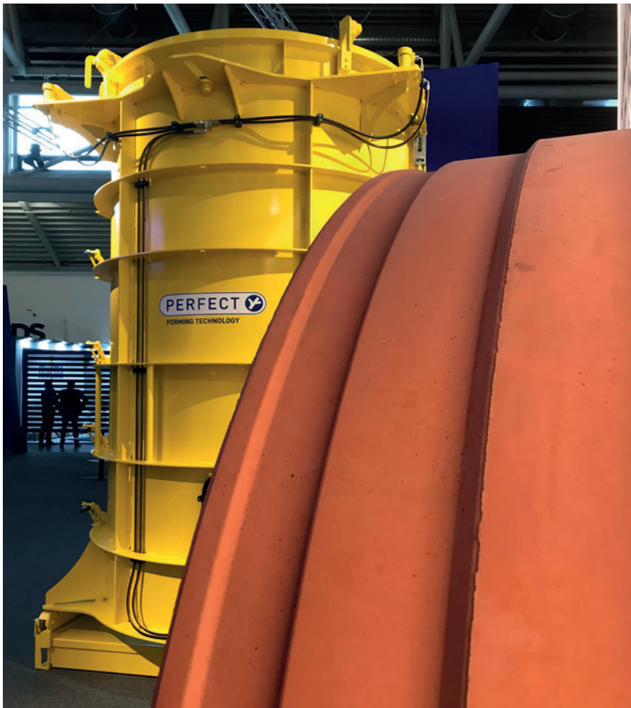
La conception sur mesure du tuyau avec chambre d'étanchéité à l'about mâle reflète les nombreuses possibilités offertes par le système de fabrication bien pensé « Perfect Forming Technology ».
