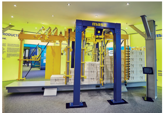
Station de découpe latérale et de profilage des articles en béton cellulaire
