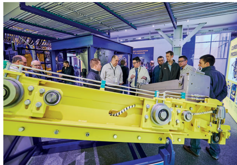
Discussions entre experts autour du chariot de remplissage de béton de parement
