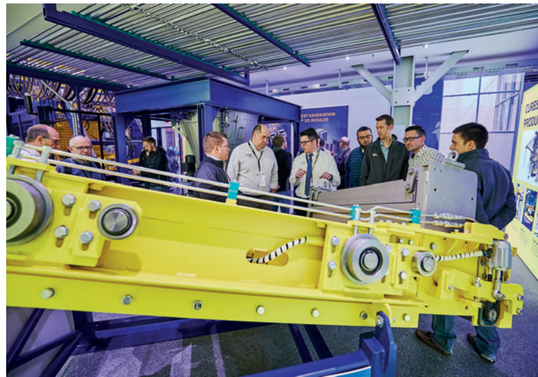
Debates técnicos junto al carro de llenado de hormigón bicapa
