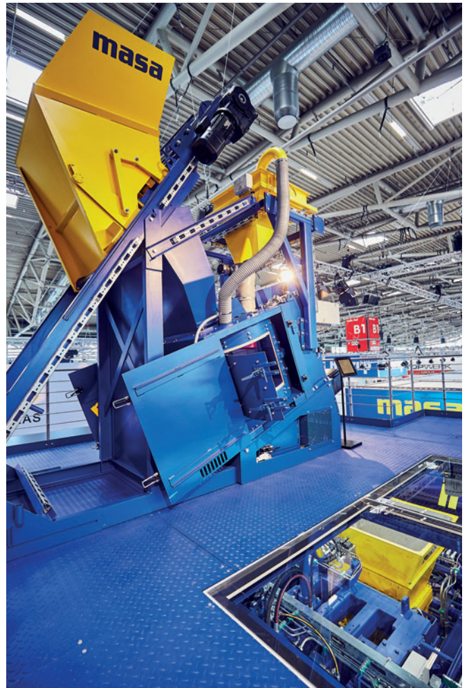
Mezcladora de hormigón bicapa S 350/500
