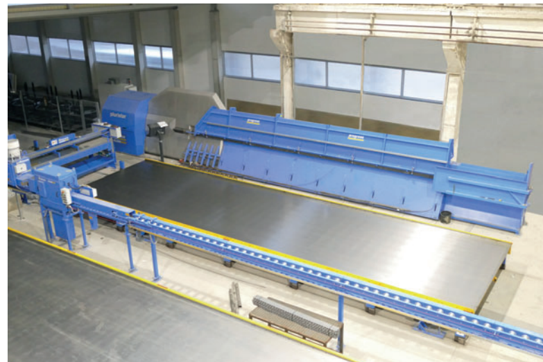
Die Pluristar von progress Maschinen & Automation ist eine automatische Bügelbiege-, Richt- und Doppelbiegemaschine. Sie wurde perfekt in die neue Ebawe -Palettenumlaufanlage integriert.
