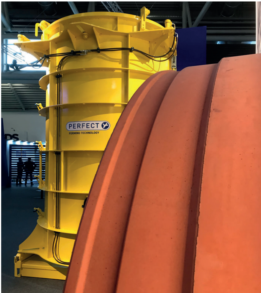
Die passgenaue Ausführung des Rohres samt Dichtungskammer am Spitzend zeigt die Möglichkeiten des durchdachten Fertigungssystems Perfect Forming Technology.
