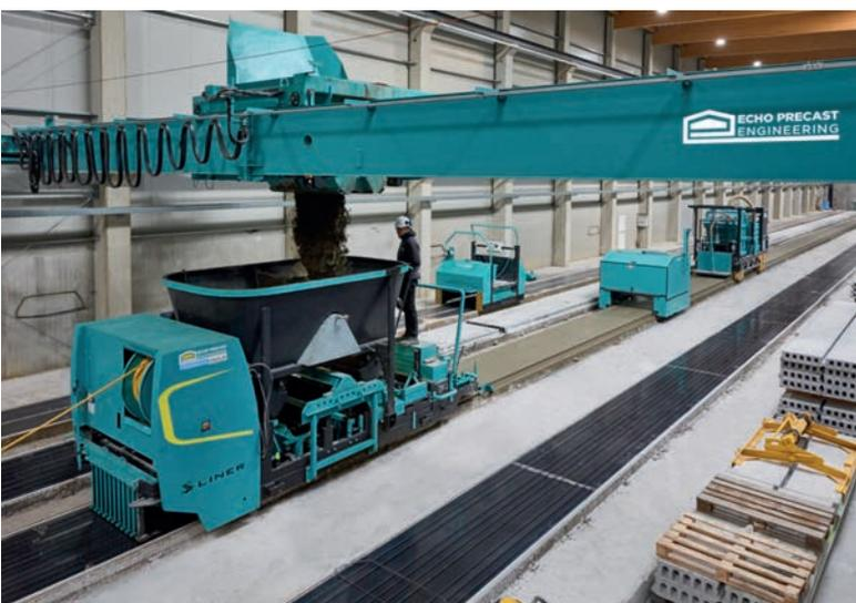
Компания Larco выпускает преднапряженные сборные ж/б элементы на четырех производственных стандах. Основой производства является слипформер S-Liner® компании Echo Precast Engineering
