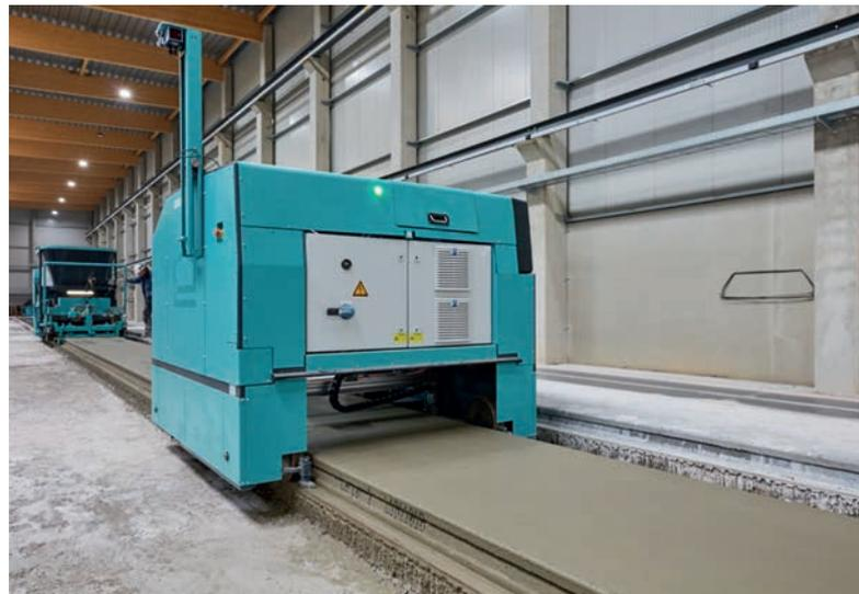
Автоматический плоттер наносит контуры в соответствии с техническим заданием проекта
