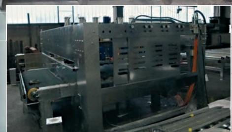
**Машины для обработки поверхности бетонных изделий**
