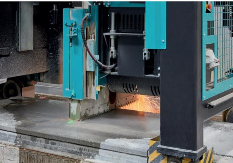
Полигональный резательный станок способен разрезать изделия на любую желаемую длину под углом 90 градусов, выполнять продольные распилы под углом 0 или 180 градусов и распилы по диагонали под любым углом в диапазоне от 90 до 180 градусов
