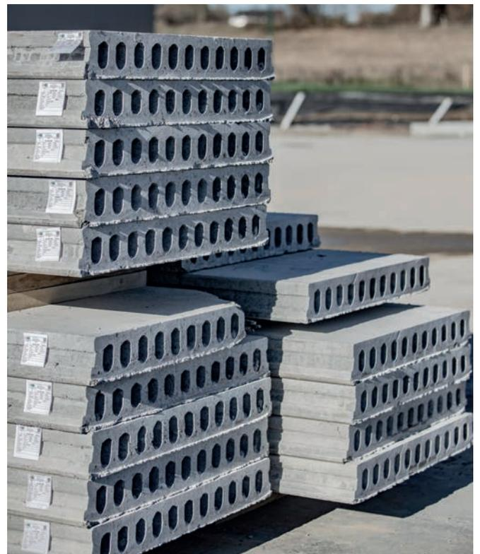
Силами 12 сотрудников компания Largo выпускает широкий ассортимент сборных ЖБИ, включая многпустотные плиты, колонны, стеновые панели, цоколи и сплошные плиты перекрытия
