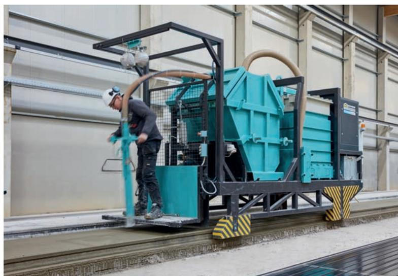
Полигональный резательный станок, автоматический плоттер, бетонораздатчик, аспиратор и многофункциональная тележка дополняют комплект оборудования, поставленного компанией Echo Precast
