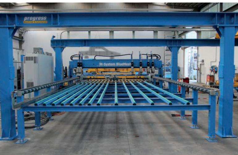
Компания Sansiri интегрировала новую систему Blue-Mesh M, сеткосварочную машину для производства арматурной сетки фирмы progress Maschinen & Automation, в свою карусельную линию по выпуску сборных железобетонных элементов
