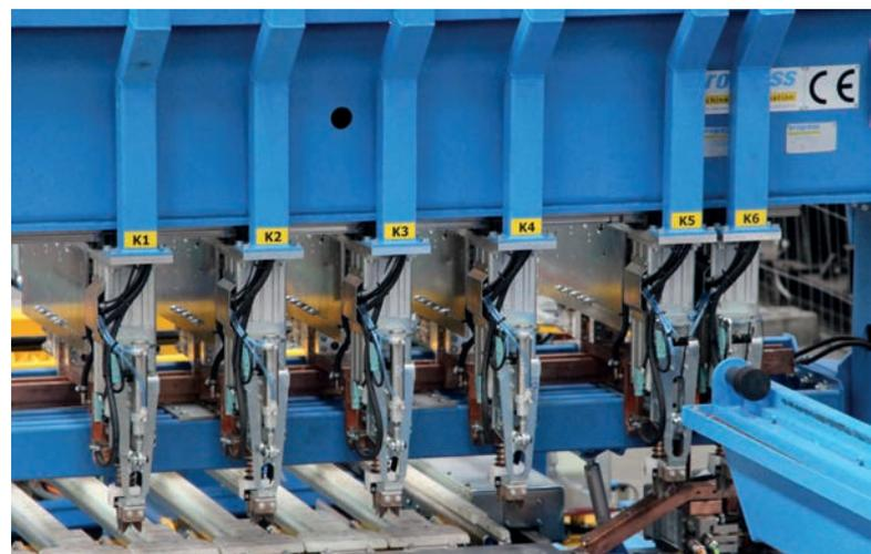
Сварочная машина спроектирована как гибкая производственная установка для сварки арматурной сетки непосредственно с бухты в соответствии с индивидуальными спецификациями
