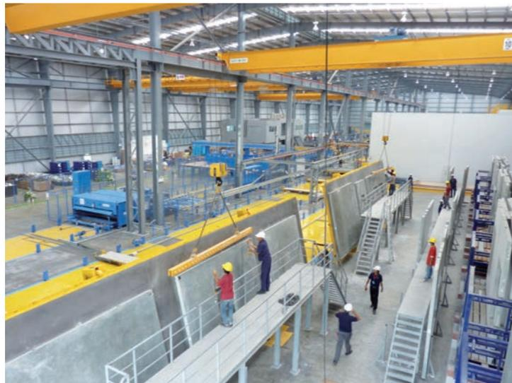
Компания Sansiri несколько лет назад приобрела высокоавтоматизированную карусельную линию Ebaawe для производства сборных железобетонных элементов для своих жилищных проектов
