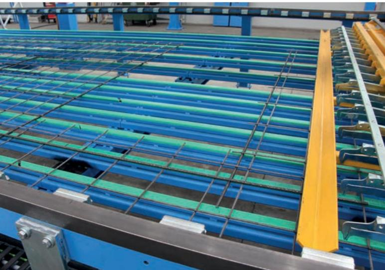
Арматурная сетка изготавливается автоматически с оконными и дверными проемами. Дальнейшей ручной резки не требуется. Это приводит к значительной экономии затрат на сырье и рабочую силу
