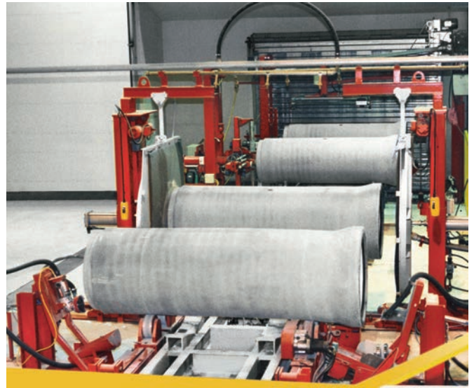
Для контроля качества бетонных труб компания Prinzing-Pfeiffer предлагает универсальный испытательный стенд
