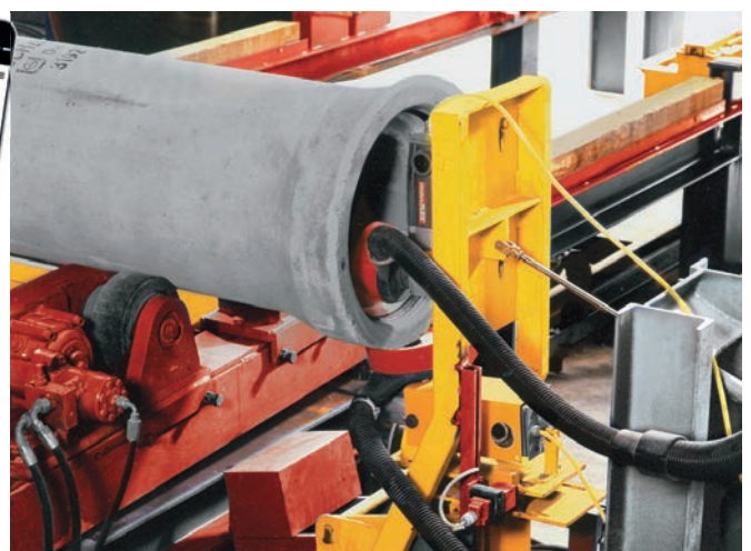
Станция удаления заусенцев для обработки внутренней и наружной поверхности раструба, а также гладкого конца бетонных труб
