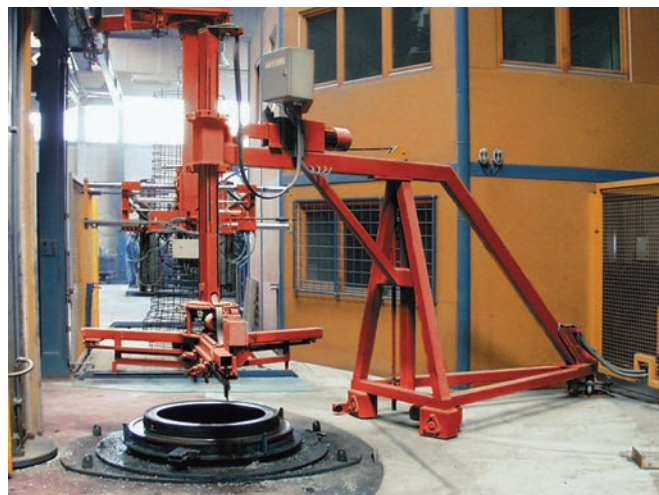
Полностью автоматический укладчик опорных муфт
