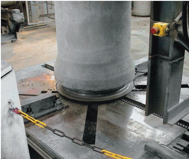
Станция извлечения опорных муфт
