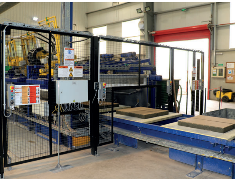
Impianto per il lavaggio dei blocchi Masa con 3 stazioni.
