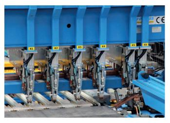
La saldatrice, un impianto di produzione flessibile per reti d'armatura direttamente dal coil, può così realizzare specifiche personalizzate.
