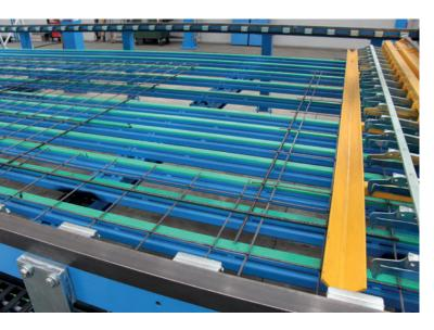
Le reti d'armatura possono essere realizzate automaticamente con aperture per finestre e porte. Non occorre più tagliare manualmente, il che consente di risparmiare sulle materie prime e sui costi del personale.
