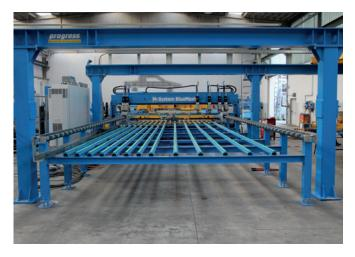
Sansiri ha integrato un nuovo impianto M-System BlueMesh, una saldatrice per reti di progress Maschinen & Automation, nell'impianto a carosello per elementi prefabbricati in calcestruzzo.
