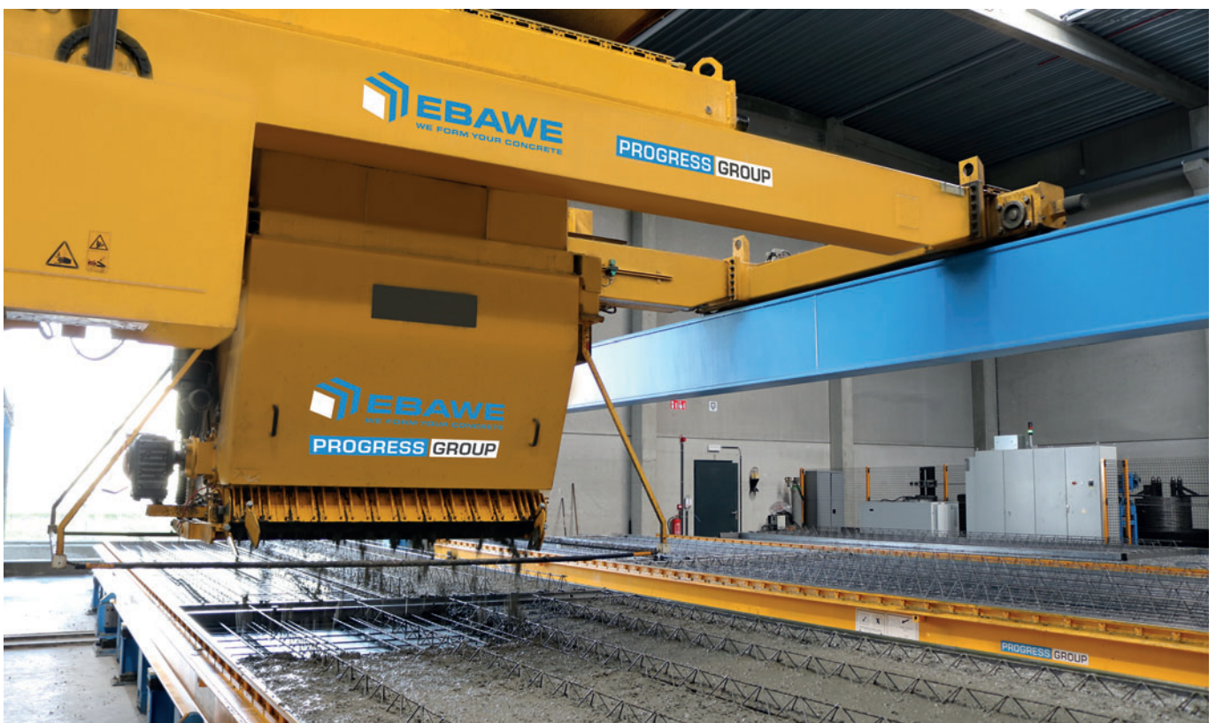
Il distributore automatico di calcestruzzo garantisce una distribuzione omogenea e ottimizzata del calcestruzzo nelle casseforme.
