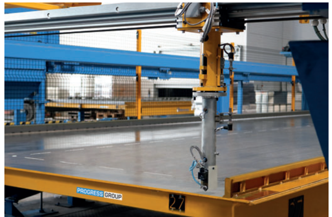
Con un plotter vengono disegnati sul pallet i contorni dei solai prefabbricati e i quadri elettrici o gli altri elementi, per rendere preciso e veloce il processo di cassetatura manuale.
