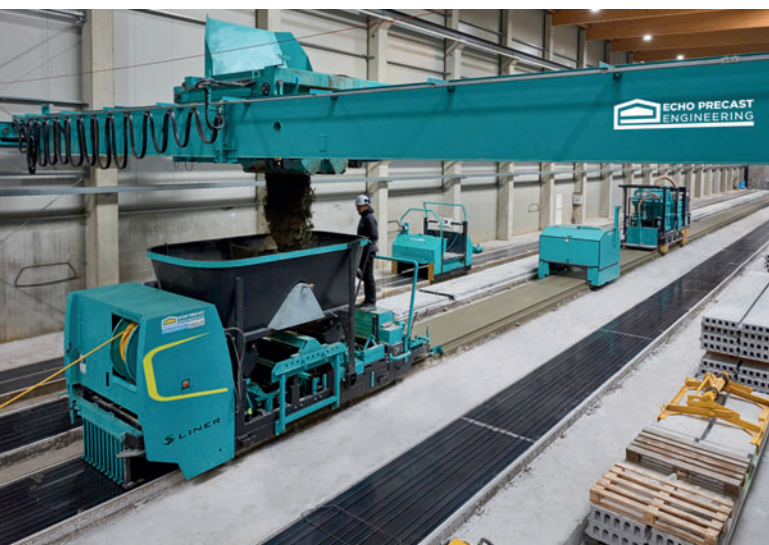
Larco produit des éléments préfabriqués en béton préfabriqué sur quatre pistes de production. Le Slipformer S-Liner® de Echo Precast Engineering est au cœur de la production.
