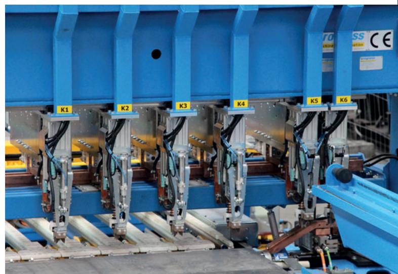
*La soudeuse est une installation flexible de production de treillis d'armature directement à partir de bobines, capable de répondre aux spécifications de chaque client.*
