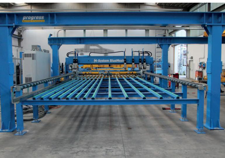
*Sansiri a intégré un nouveau système M-System BlueMeshM, une machine de soudage de treillis de progress Maschinen & Automation, dans le carrousel à palettes pour éléments préfabriqués en béton.*
