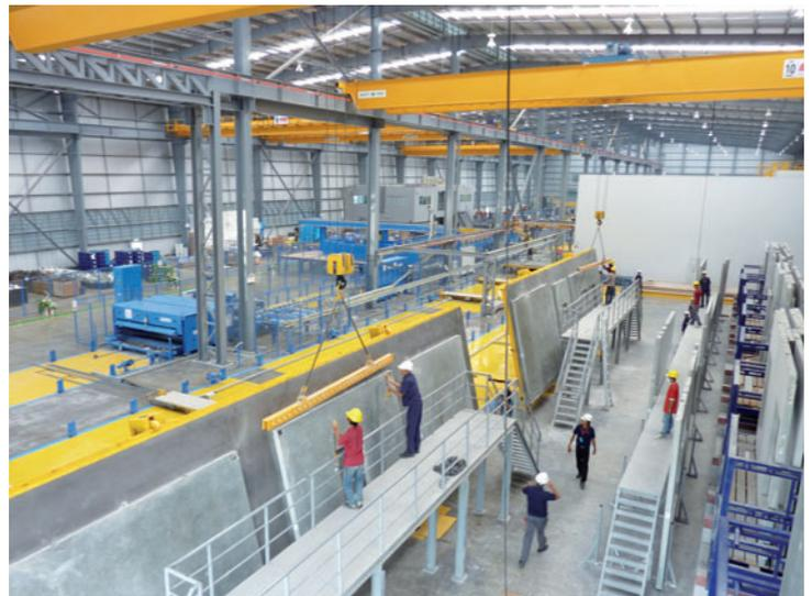
Il y a quelques années, Sansiri a déjà acheté à Ebawe un carousel à palettes hautement automatisé pour la fabrication d'éléments préfabriqués en béton destinés à des projets immobiliers.
