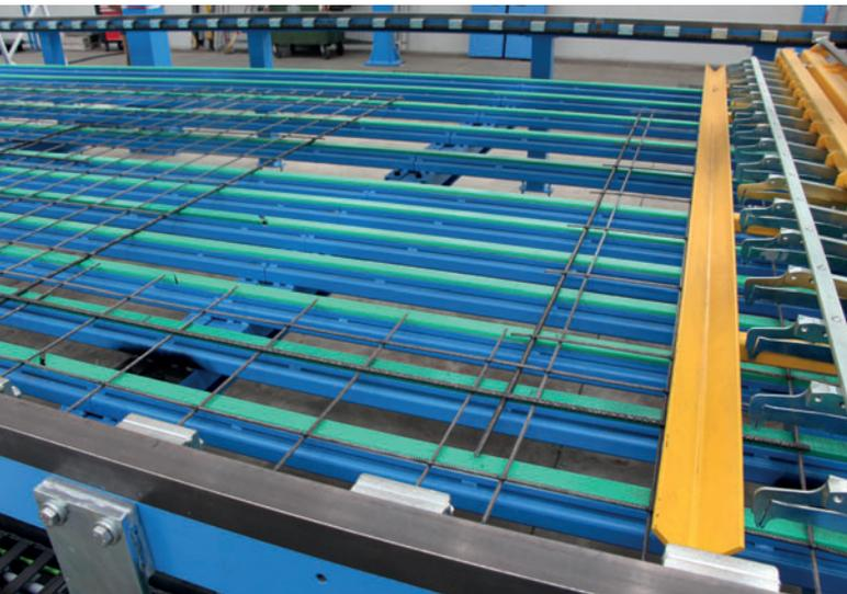
Les treillis d'armature peuvent être fabriqués automatiquement avec des évidements pour les fenêtres et les portes. Aucune découpe manuelle n'est requise pour ce faire. Cette technique permet d'économiser des matières premières et de réduire les frais de personnel.
