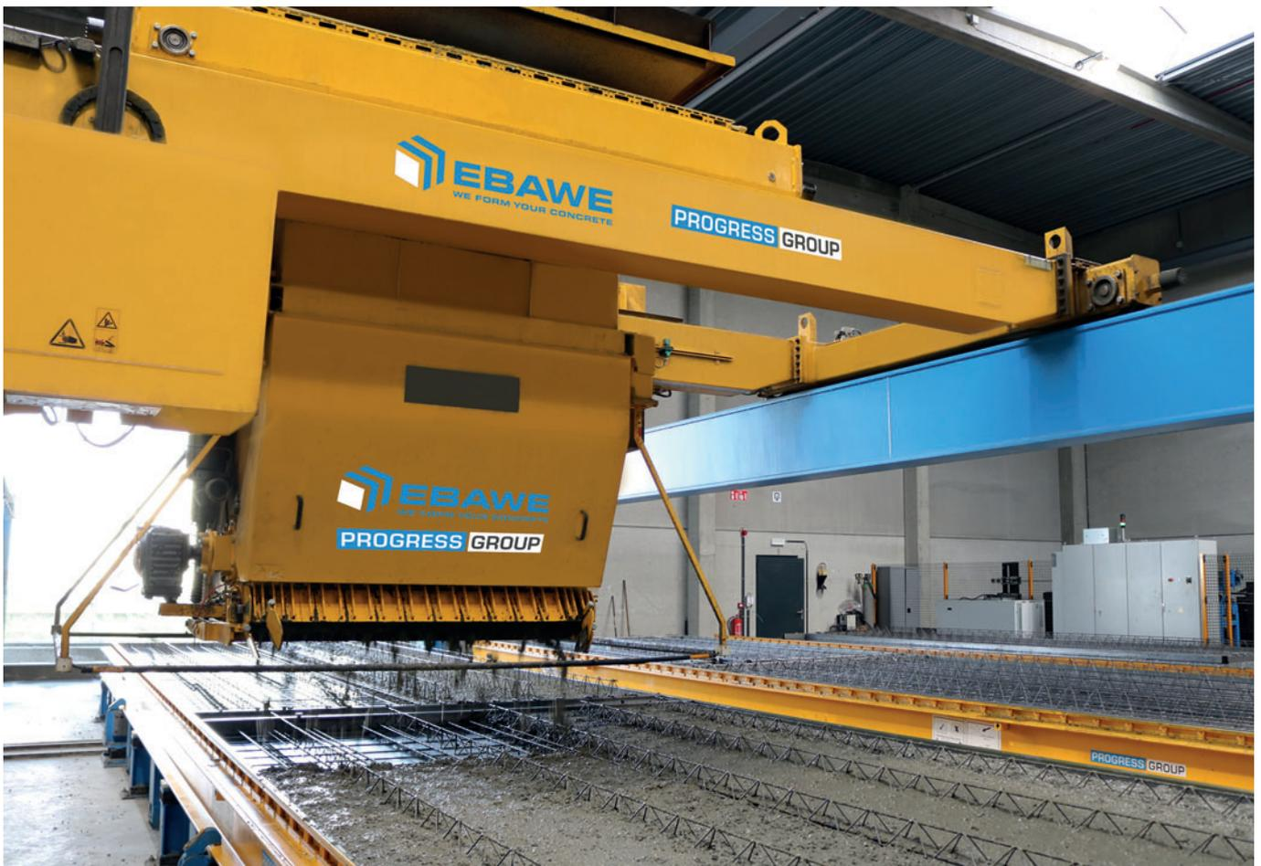
*Le distributeur de béton automatique assure une répartition uniforme et optimisée du béton dans les coffrages.*
