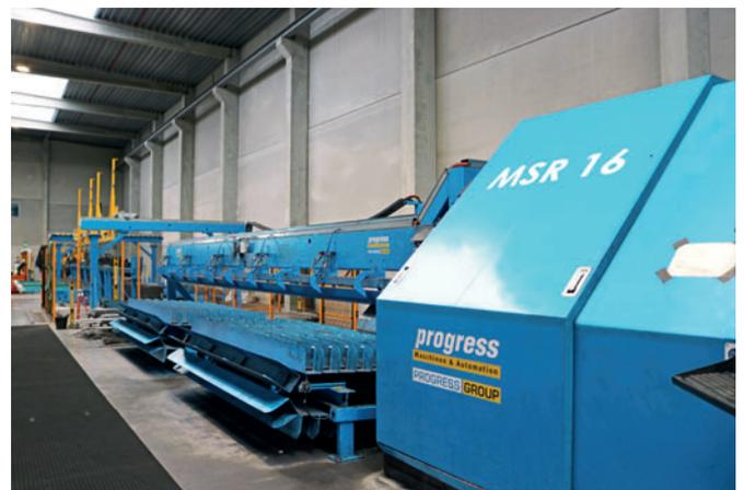
*La redresseuse / coupeuse / cintreuse MSR 16 de la société Progress travaille directement à partir des bobines et optimise le flux de production. De faibles coûts de stockage et une maintenance plus simple des matériaux assurent une production rentable.*
