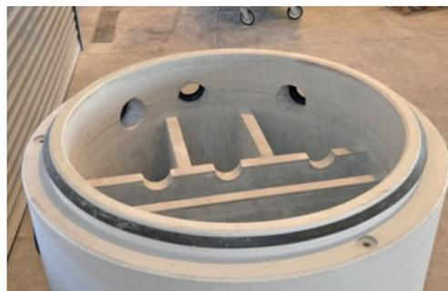
*Le système de fabrication Perfect permet de réaliser de manière économique des fonds de regards ainsi que des structures spéciales telles que des collecteurs d'eau de source.*
