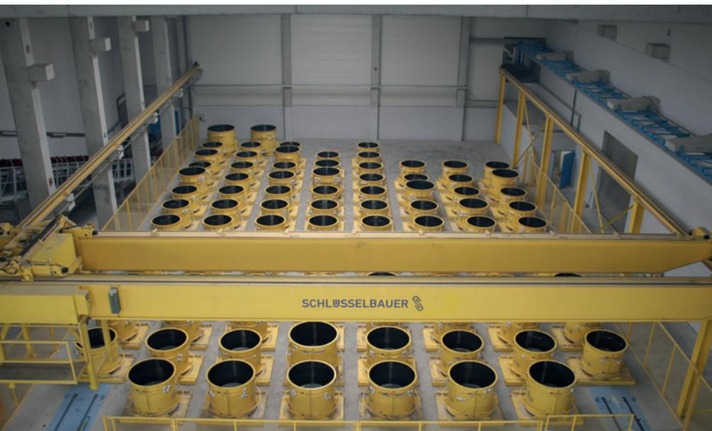
*Alors que les composants durcis en moule étaient principalement produits en fabrication simple durant des décennies, Schlüsselbauer Technology a développé des systèmes de production de masse à l'appui de l'utilisation de béton autocompactant.*
