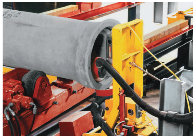
Station d'ébavurage pour le ponçage du diamètre intérieur et extérieur de la cloche ainsi que pour la finition de l'embout mâle de tuyaux en béton
