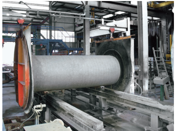
Appareil de test de tuyaux sous vide pour le contrôle d'étanchéité
