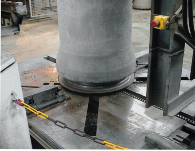
Station d'extraction des rondelles de base
