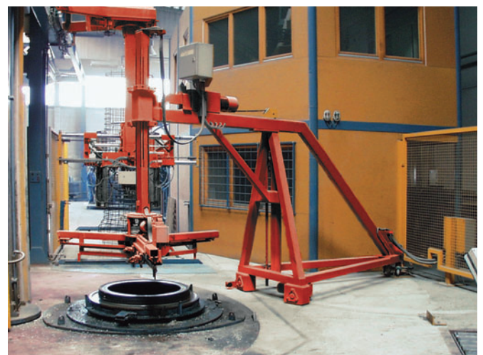
Rondelle de base entièrement automatique - dispositif d'insertion
