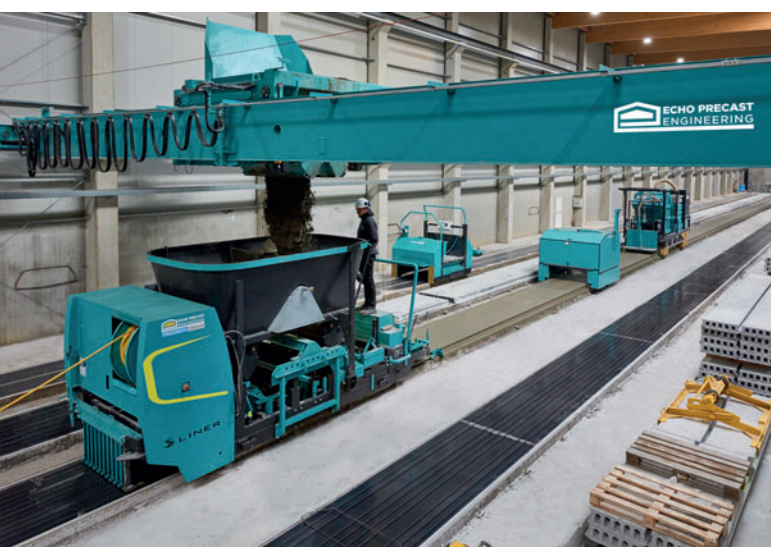
Larco fabrica prefabricados de hormigón pretensado en cuatro líneas de producción. La máquina principal de la producción es la máquina deslizante S-Liner® de Echo Precast Engineering
