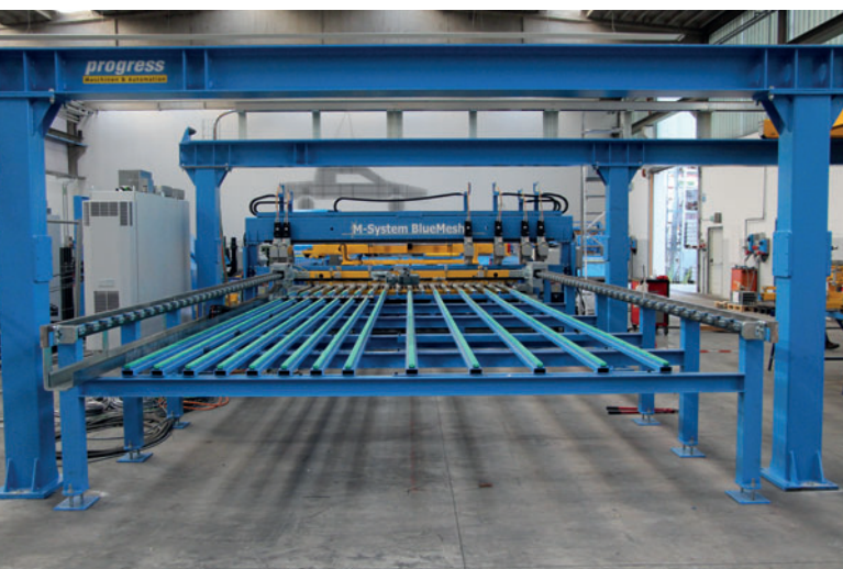
Sansiri ha integrado un M-System BlueMesh, una máquina soldadora de mallas de Progress Maschinen & Automation, en el carrusel de bandejas para prefabricados de hormigón.
