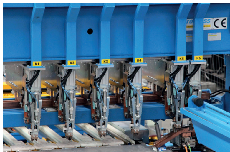
La máquina soldadora es una instalación de producción flexible para mallas de armadura fabricadas directamente partiendo desde bobina y puede realizar especificaciones individuales.
