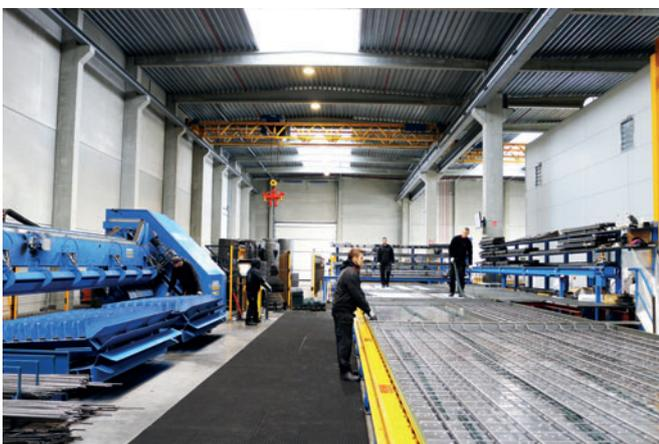
Ya en la fase de planificación de la nueva instalación a carrusel de bandejas, Predalco se centró en un planteamiento combinado de circuito de carrusel y máquina de armaduras, con el fin de garantizar un proceso de producción global sin problemas.
