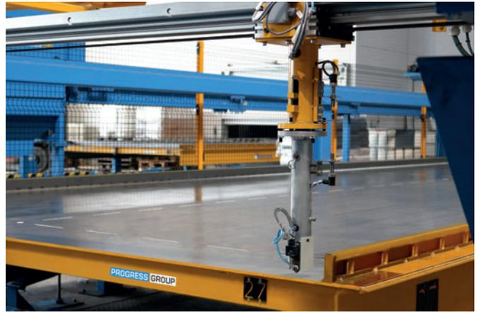
Gracias a un plóter, en la paleta se dibujan los contornos de los forjados prefabricados de hormigón al igual que las cajas eléctricas u otros elementos, a fin de preparar un proceso de encofrado manual preciso y rápido.
