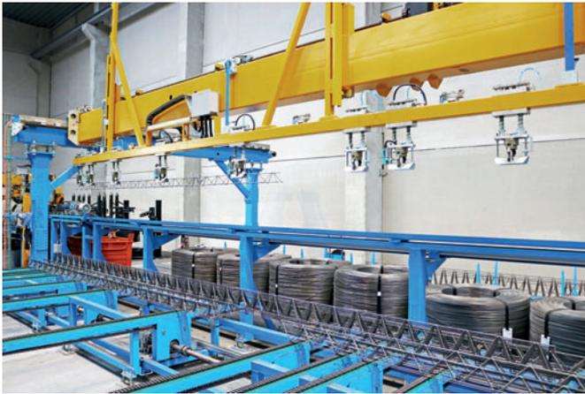
Las máquinas de soldadura de armadura de celosía y de manipulación de Progress de la serie VGA Versa son las mejores para una producción flexible y orientada a las necesidades de vigas de celosía.
