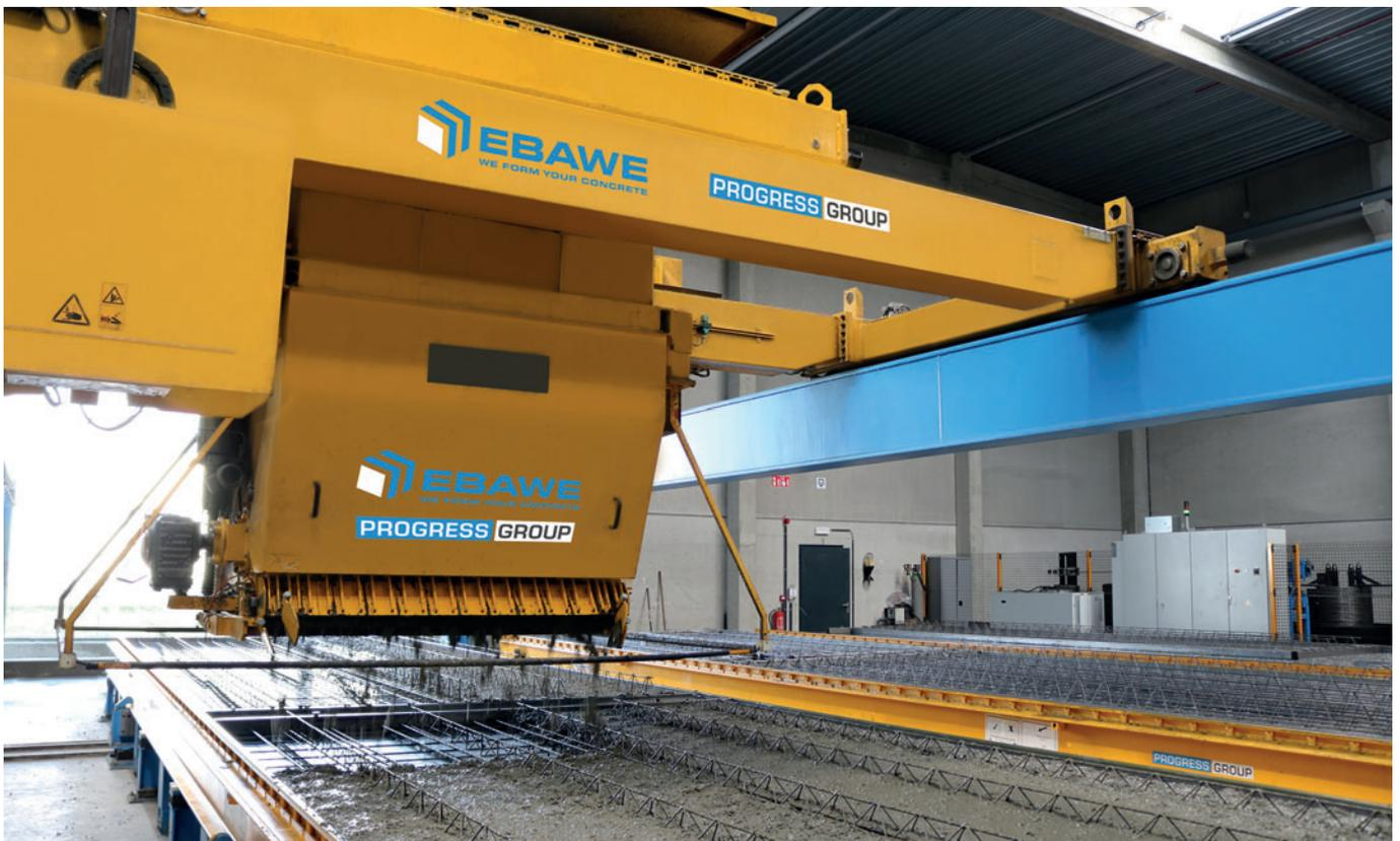
El distribuidor de hormigón automático garantiza una distribución uniforme y optimizada del hormigón en los encofrados.
