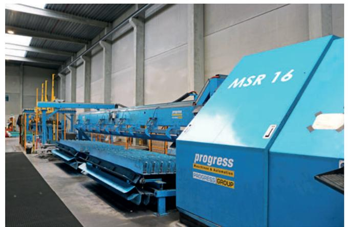
La máquina de enderezado, corte y curvado MSR 16 de Progress funciona directamente desde la bobina y optimiza el flujo de producción. Unos costes de almacenamiento reducidos y una sencilla manipulación del material aseguran una producción rentable.
