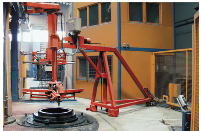
Equipo de colocación de coronas base completamente automático
