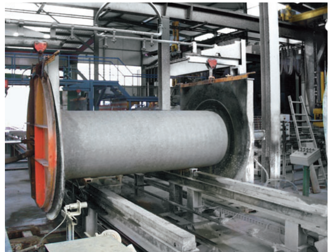
Equipo de comprobación de tubos por vacío para la comprobación de la estanqueidad
