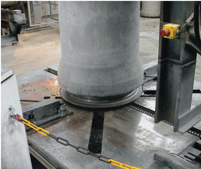
Estación de expulsión de coronas base
