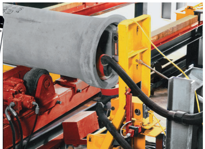
Estación de desbarbado para procesar el diámetro interior de la campana y el diámetro exterior, así como la boquilla macho de tubos de hormigón
