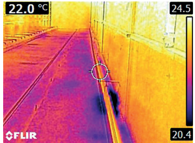
Un pasillo de plataforma corredera típico con pared exterior aislada. Se aprecian perfectamente varios puntos húmedos, en la imagen térmica se aprecia el frío del suelo en la zona del pasillo de la plataforma corredera como consecuencia de una circulación de aire deficiente. Las zonas de color violeta oscuro en la pared exterior muestran el frío que entra por el suelo
