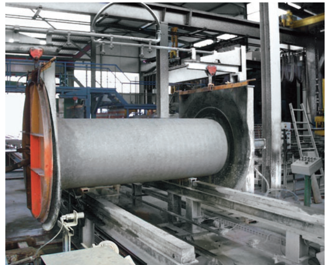
Vakuum-Rohrprüfgerät für die Dichtigkeitsprüfung
