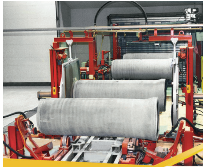
Zur Kontrolle der Rohrqualität bietet Prinzing-Pfeiffer eine Rohrprüfstraße
