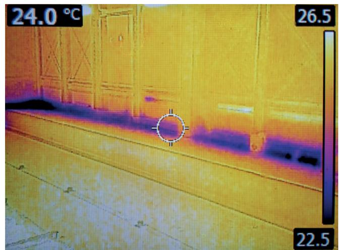
*Diese Wärmebilder zeigen eine gut beheizte und belüftete Härtungskammer – der lediglich die Isolierung der Betonbodenplatte im Bereich der Kammerwand fehlt. Der Boden im Schiebebühngang ist leuchtend gelb bis orange, verfärbt sich dann zur ungeschützten Bodenplatte hin aber ins dunkle Violett, besonders deutlich im zurückgesetzten Teil des Schiebebühngangs. Der Einsatz einer Isolierung an diesem Teil der Betonplatte würde die Gefahr von stehendem Wasser beseitigen.*
