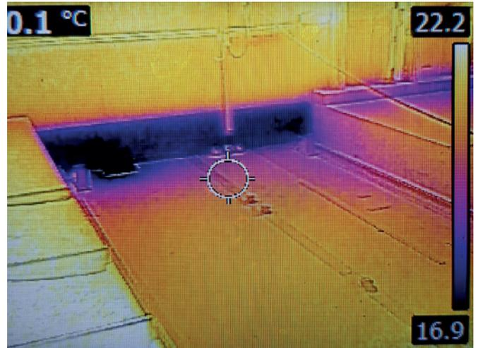
Die dunkelvioletten Bereiche an der Kammerwand werden zur Kammermitte hin heller. Das Vorhandensein großer violetter Bereiche deutet auf mangelhafte Luftzirkulation hin.
