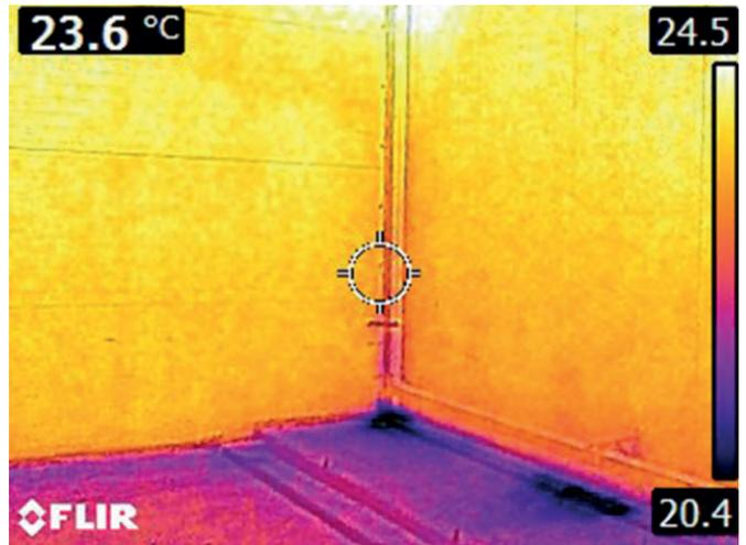
Der Betonboden in dieser Ecke der Härtungskammer ist der von außen hereinziehenden Kälte ausgesetzt. Das kalte, stehende Wasser ist als dunkelvioletter Fleck auf dem Wärmebild zu sehen.
