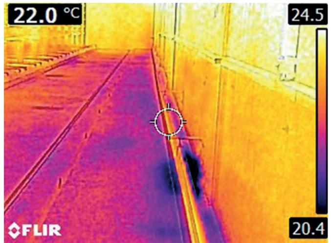
Ein typischer Schiebebühnengang mit isolierter Außenwand. Mehrere feuchte Stellen sind zu sehen, auf dem Wärmebild ist die Kälte des Bodens im Bereich des Schiebebühnengangs als Folge mangelnder Luftzirkulation gut zu erkennen. Die dunkelvioletten Bereiche an der Außenwand zeigen die durch den Boden hereinziehende Kälte.
