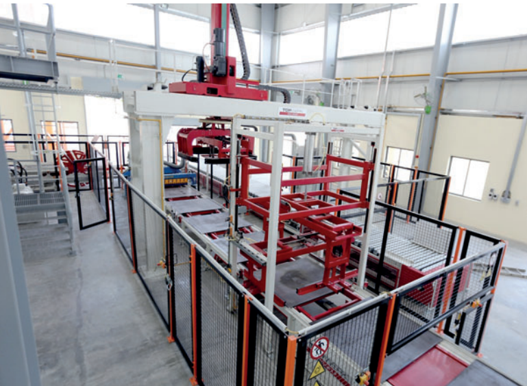
Vollautomatisiertes Transfer- und Handlingsystem
