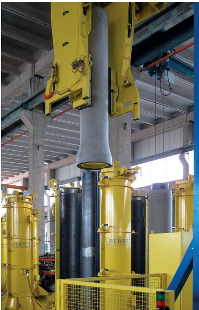
*L'utilizzo di Perfect Forming Technology facilita enormemente la produzione di tubi in calcestruzzo di alta qualità: i prodotti induriti possono essere - indipendentemente dal grado di automazione - facilmente disarmati.*
