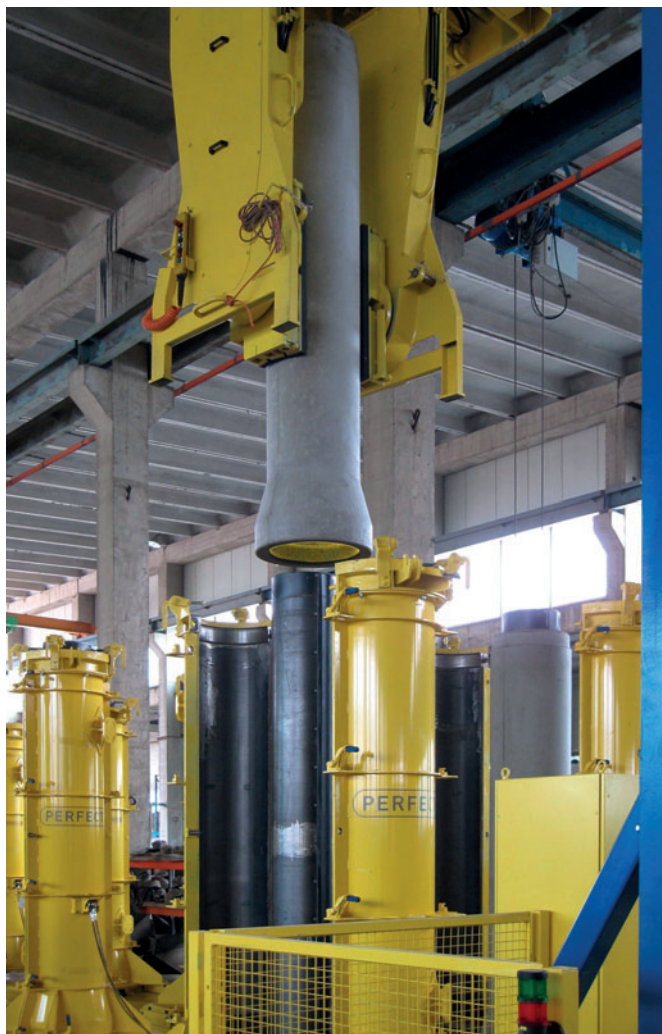
L'utilisation de la Perfect Forming Technology facilite grandement la fabrication de tuyaux en béton de grande qualité : les produits durcis peuvent être démoulés facilement et ce quelque soit le degré d'automatisation.
