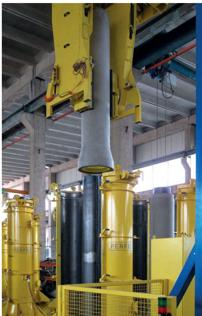
El uso de Perfect Forming Technology facilita enormemente la producción de tubos de hormigón de gran calidad: los productos endurecidos se pueden desencofrar fácilmente, con independencia del nivel de automatización.
