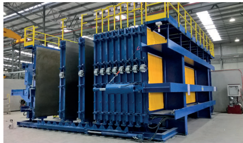
El encofrado en batería de Tecnom se instaló recientemente en BGC, la primera empresa que utiliza esta tecnología en Australia Occidental.
