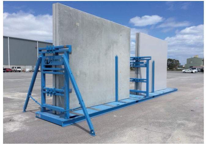
Los elementos de muro fabricados con encofrados en batería de Tecnom ofrecen una excelente calidad y características superficiales excepcionales. Ambos lados del muro presentan una calidad superficial lisa de encofrado. (Foto: BGC)
