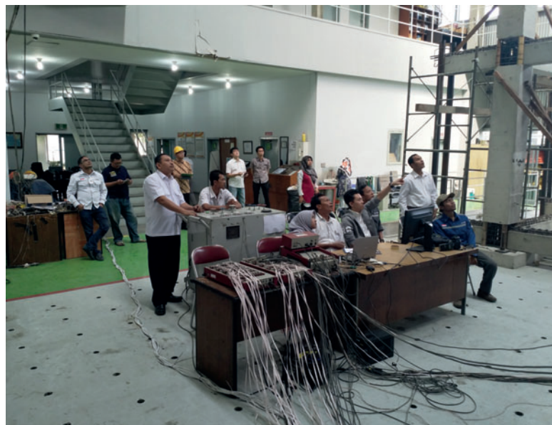
На испытательном полигоне тестовое здание из сборных ж/б элементов прошло проверку на сейсмостойкость
