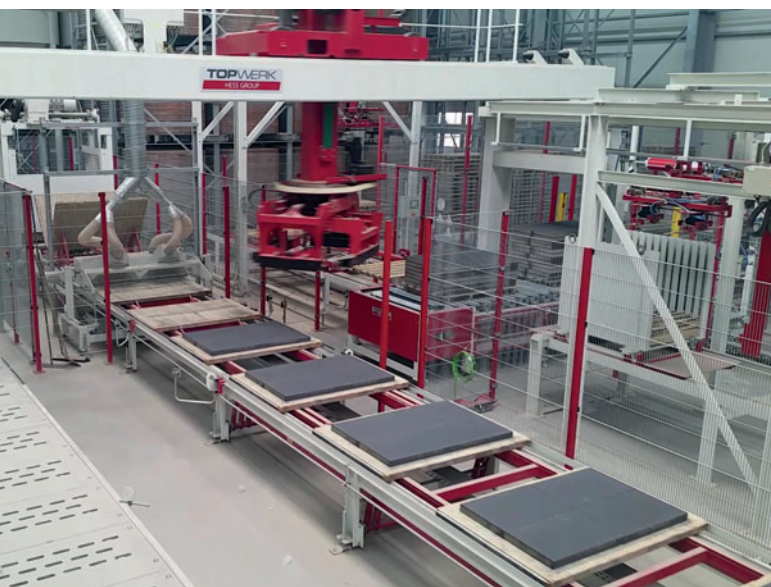
La seconda impacchettatrice ha accesso alla linea di trattamento e alla linea "normale".
