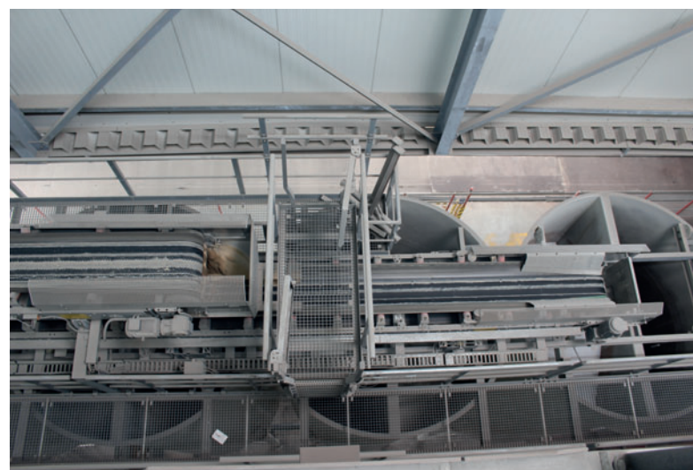
Un nastro di distribuzione anche in questo caso garantisce il corretto caricamento dei singoli sili.
