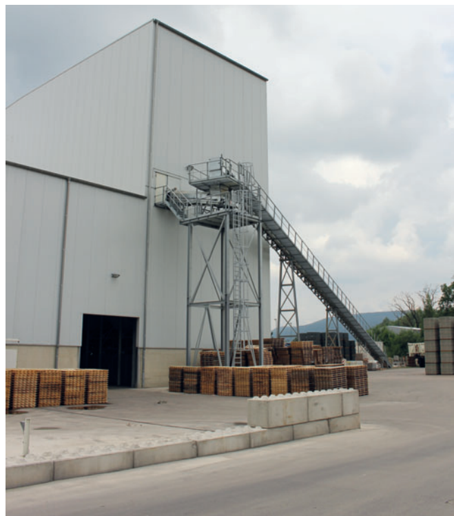
Gli aggregati per il calcestruzzo per lo strato di rivestimento vengono trasportati ai silos con un nastro trasportatore inclinato.
