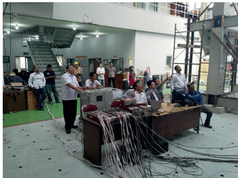
*In un organismo di prova dei materiali da costruzione si è provveduto a sottoporre un edificio di prova realizzato con elementi prefabbricati in calcestruzzo a un test sismico.*
