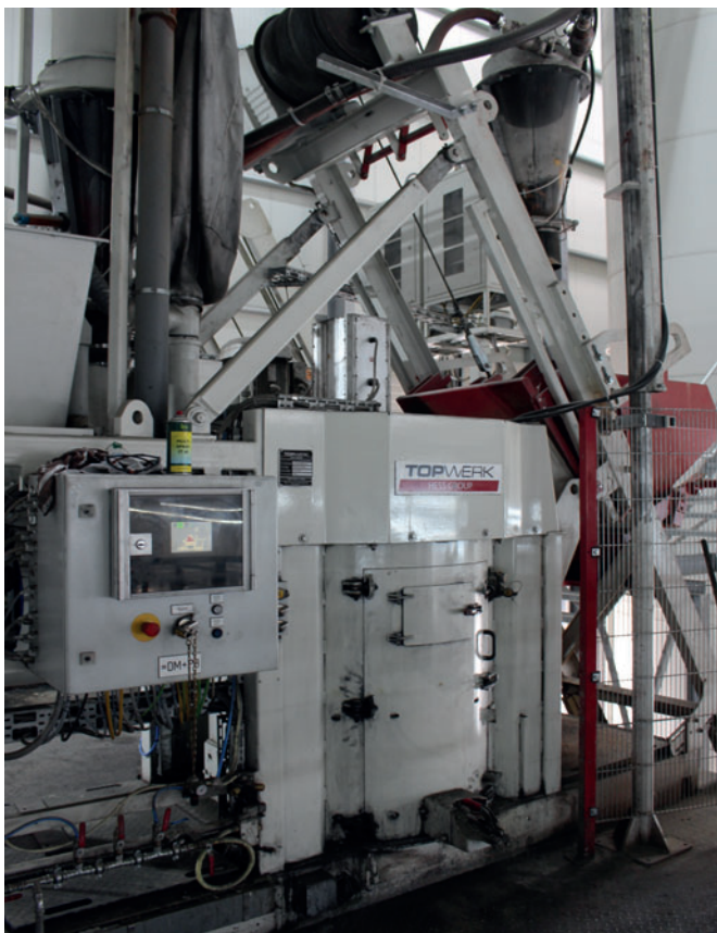
Le malaxeur Hess SM 400 produit le béton de parement.
