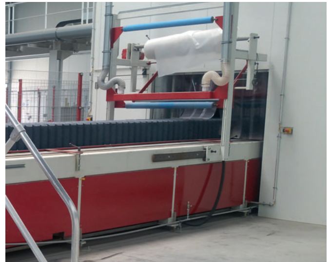
La finition des produits en béton fait appel à une installation de vieillissement Mega 6000 Duo de SR-Schindler côté sec, intégrée au système sous forme de by-pass.
