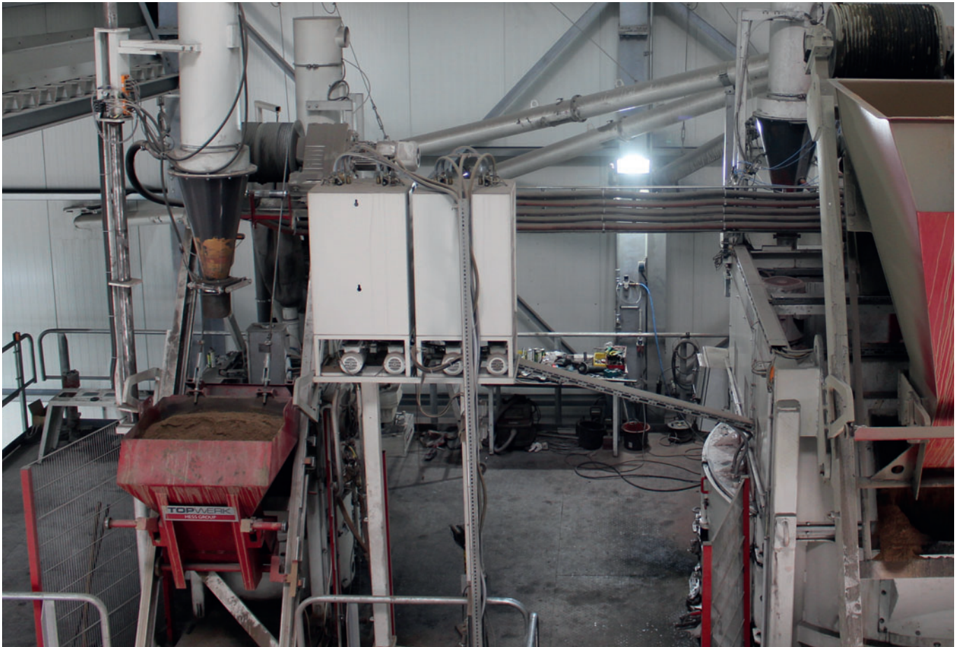
Hess a installé deux malaxeurs de la série SM sur une plate-forme ad hoc pour la production de béton.
