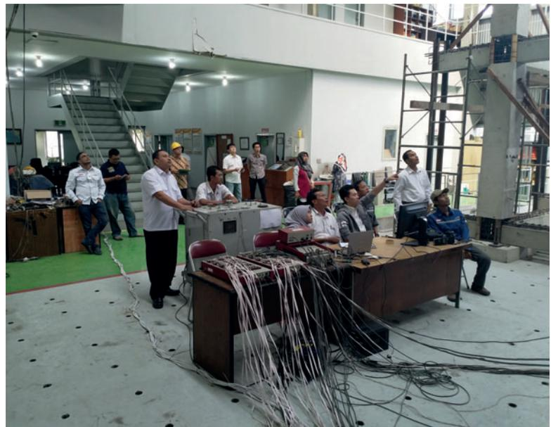
*Una estructura de prueba de elementos prefabricados de hormigón fue sometida a un ensayo sísmico en un centro de ensayo de materiales.*
