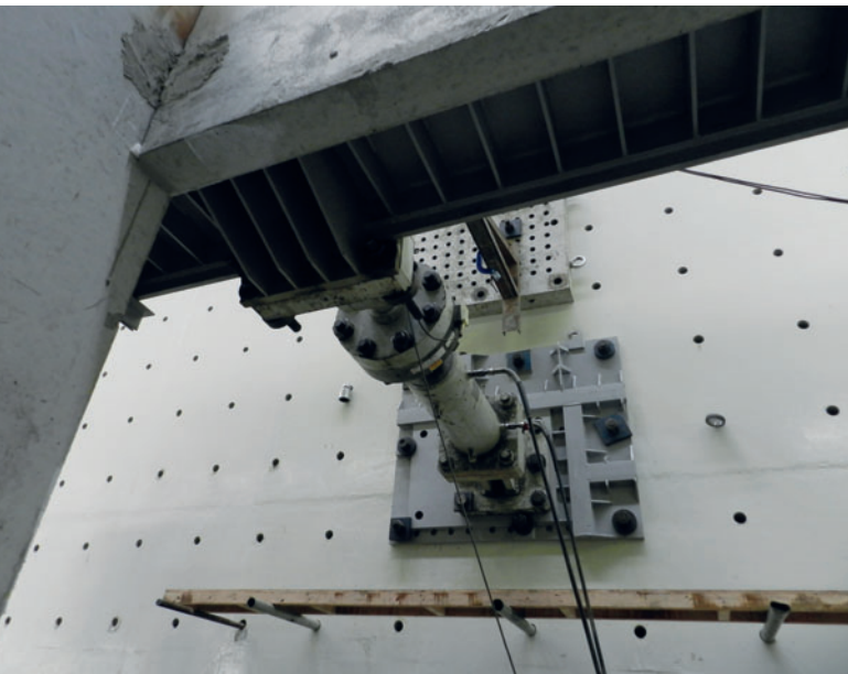
Das Musterhaus wurde einer Belastung entsprechend einem durchschnittlich alle 2.500 Jahre auftretenden Erdbeben getestet; auf der Richterskala entspricht dies einer Stärke von mehr als 8.
