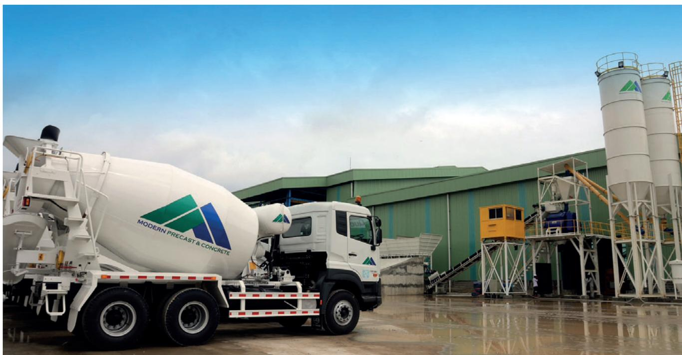
Производительность новой БСУ составляет  $500 \text{ м}^3$  за смену. В настоящее время автопарк компании Modern Precast насчитывает шесть автобетоносмесителей объемом  $7 \text{ м}^3$  каждый
