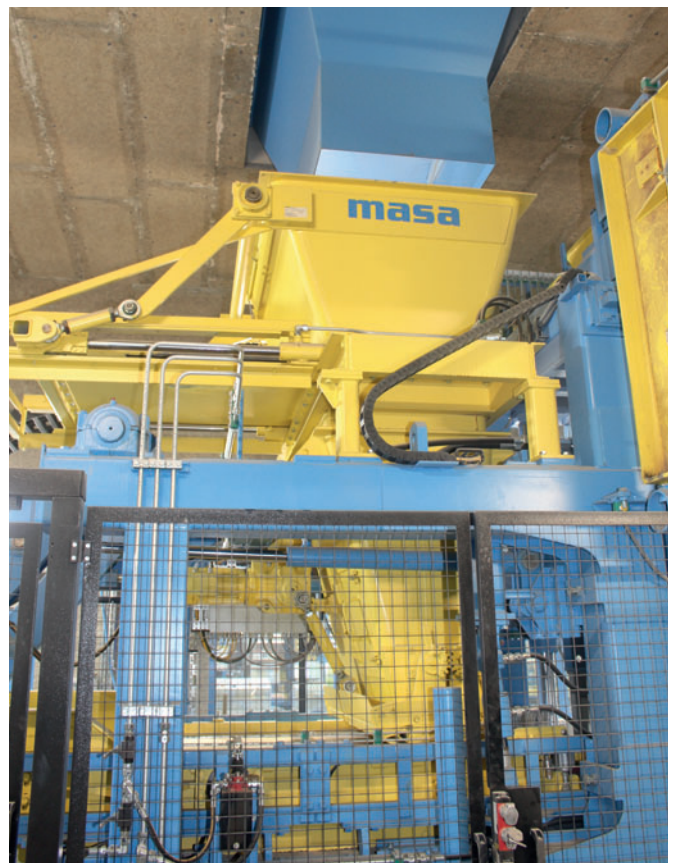
I silii del calcestruzzo per lo strato interno e per quello di rivestimento sono dotati di celle di pesatura.
