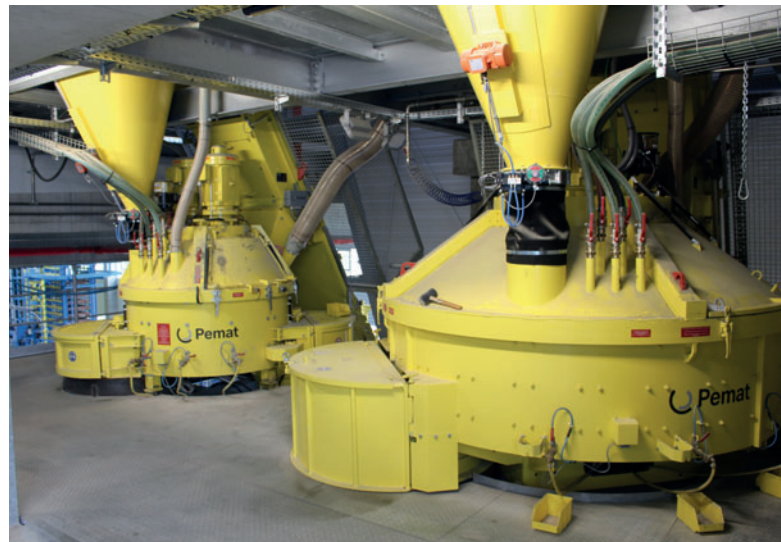
Potenti miscelatori planetari Pemat per una produzione continua del calcestruzzo
