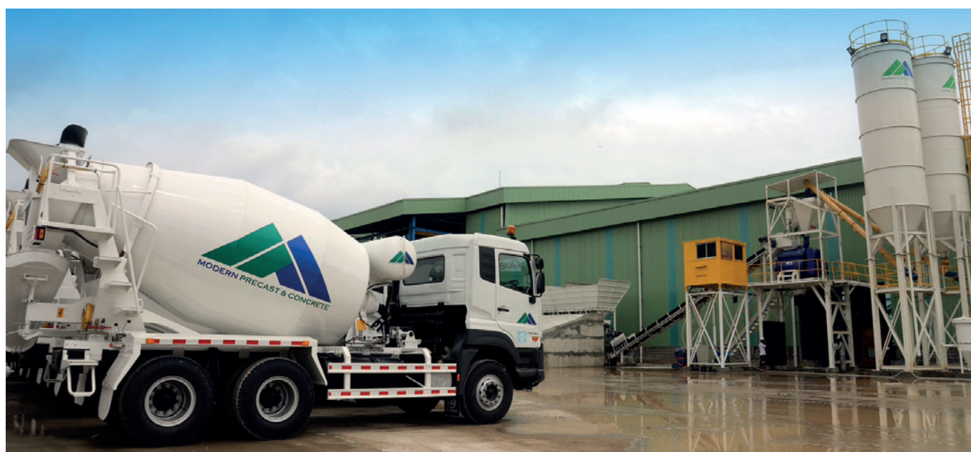
Il nuovo impianto di miscelazione ha una capacità di 500 m 3 a turno. Attualmente Modern Precast lavora con sei autobetoniere di 7 m 3 ciascuna.
