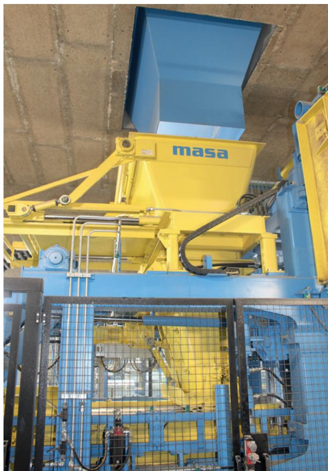
Les silos pour le béton de corps et de parement sont dotés de cellules de pesage.
