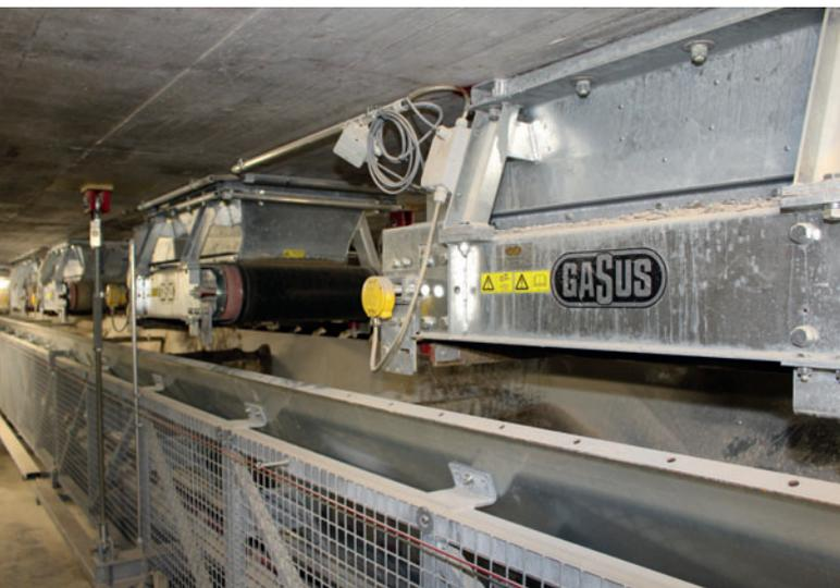
Avec un débit de 3.000 kg/min, des bandes doseuses pêsent par addition les différents granulats sur un convoyeur de pesage.
